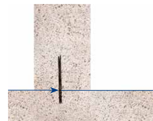
Water wordt tegengehouden in de stortvoeg
