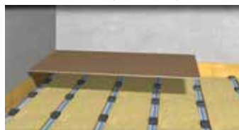
Verloren bekisting aanbrengen
