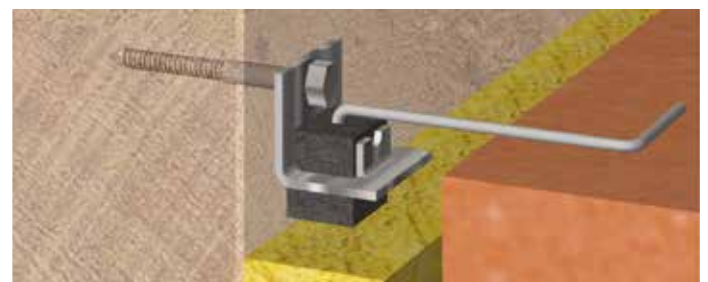
U-vormige houder inwerken in de metselwerkvoegen
