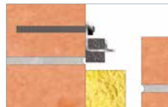
Bevestiging met draadstang M8 + chemische verankering
