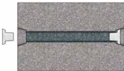
2x kegel inlijmen
