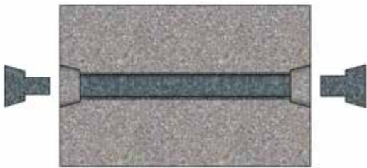
Direct na ontkisten voorzetconussen verwijderen
