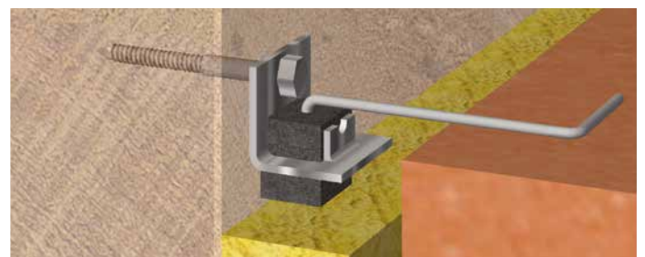
U-vormige houder inwerken in de metselwerkvoegen
