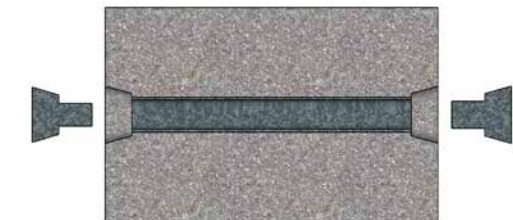
Direct na ontkisten voorzetconussen verwijderen
