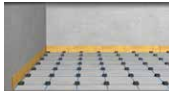
Rubber blokken aanbrengen
